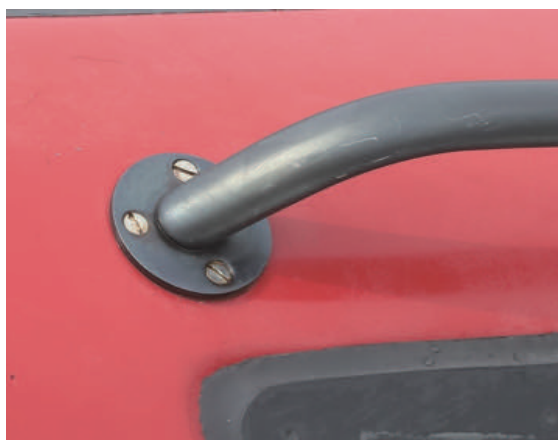
【ORORU処理®以外のステンレス状態】 所見: 白色斑点が見られ表層が酸化し錆びが発生している。
